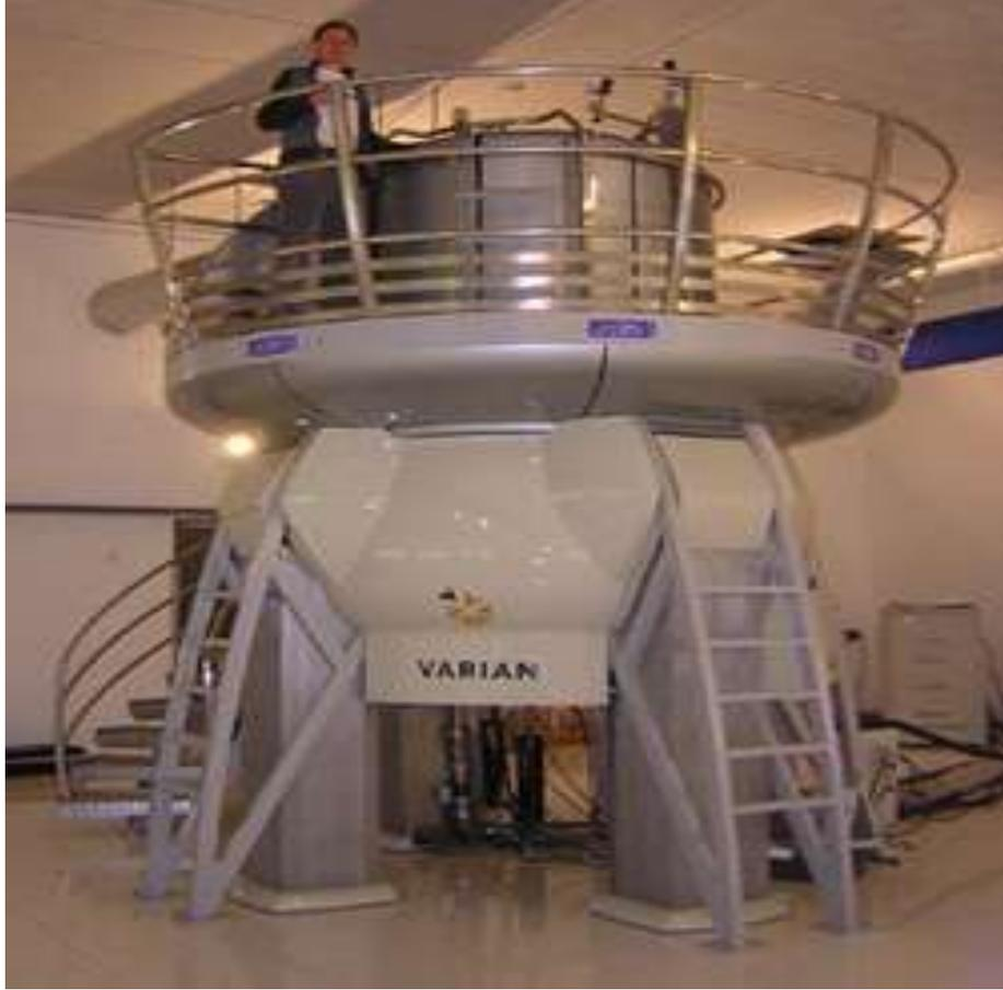
شكل (3-6): مطياف الرنين النووي المغناطيسي
